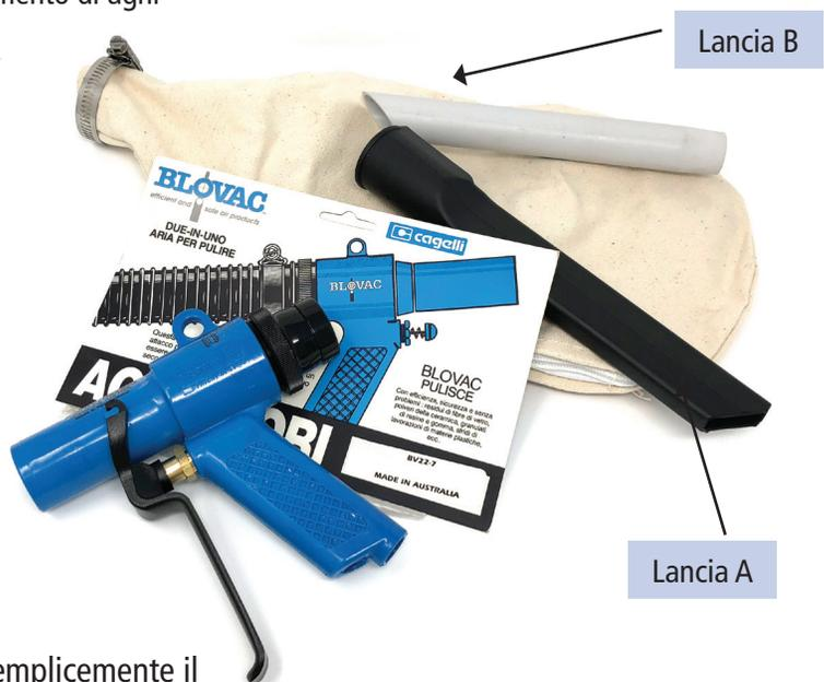
La pistola BV 22 può soffiare oppure aspirare invertendo semplicemente il Venturi. Il modello BV 22 D/H può aspirare e soffiare contemporaneamente.
