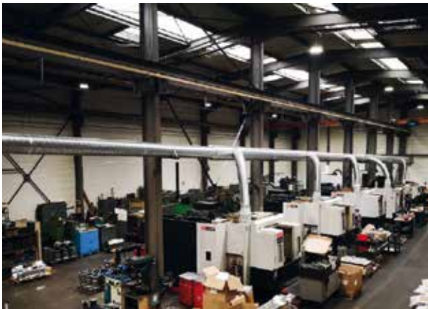
Esempio di installazione per emissione aria in esterno
