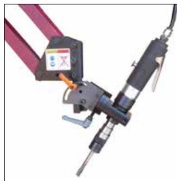
Il modello verticale è dotato del dispositivo angolare di maschiatura.
