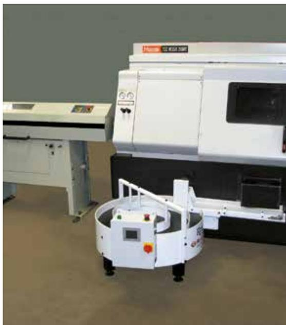
■ Equipaggiare il vostro tornio CNC con il Royal Rota-Rack vuol dire eliminare i rischi di danneggiamento dei pezzi ma soprattutto Vi farà guadagnare ore extra di lavoro al giorno, senza la necessità di presenziare la macchina!
