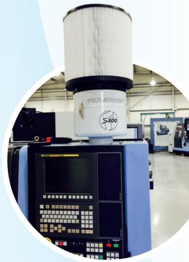
Grazie al nuovo filtro Filtermist Submicron, dopo un test di 3500 ore di lavoro ininterrotte, il flusso d'aria si è ridotto solo del 14%.
