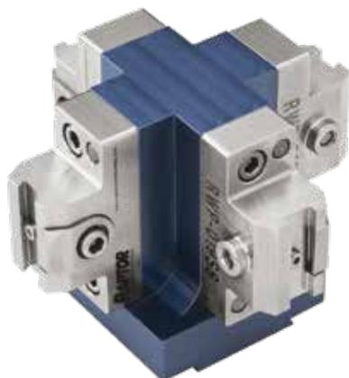
Il mini cubo Raptor utilizza 4 morse a coda di rondine RWP-019SS da 0.375" montate con un angolo di 90 gradi. Ha una base a coda di rondine da 1.5" e si fissa su altre morse Raptor per un ricambio facile e veloce. I tempi di lavorazione vengono ridotti e **la produttività della vostra macchina viene drasticamente aumentata.**
