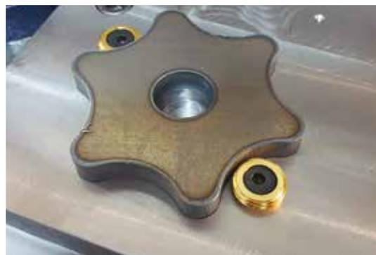
Questi morsetti vengono utilizzati per staffare pezzi grezzi oppure di fusione e pezzi con superfici curvilinee.
