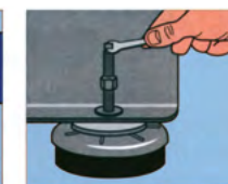
Avvitare o svitare il perno per il posizionamento.
