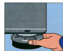
Alzare la macchina e posizionare il supporto.
